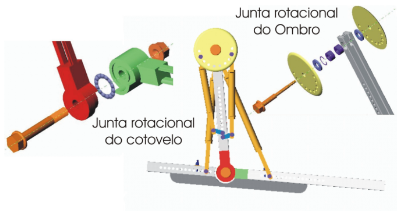
Figura 24 – Aspecto final da estrutura proposta tendo em conta os pormenores mecânicos.
