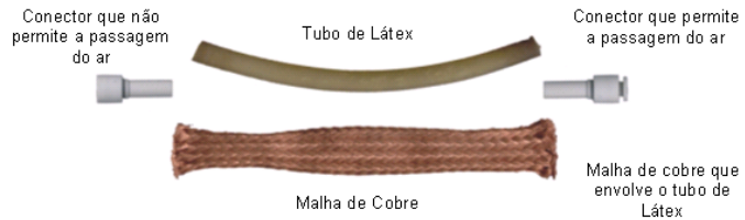
Figura 7 – Componentes do músculo pneumático
